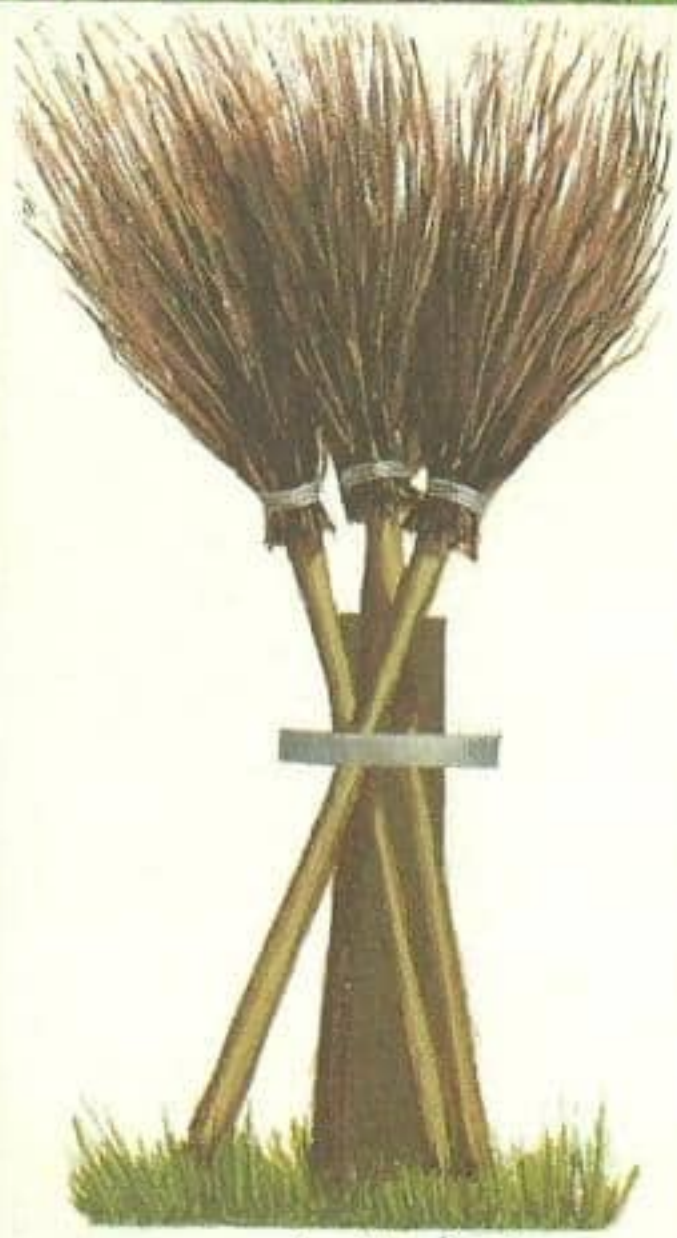
مخابيط إطفاء الحريق
